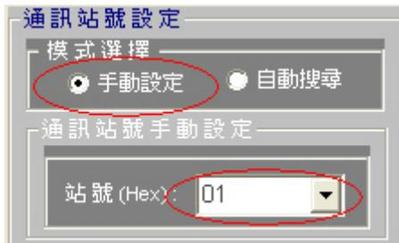
→ **自動搜尋**：會直接根據目前設定的通訊埠，通訊格式，自動搜尋目前線路上的 MTC-3 系列的站號，搜尋方式從 01 至 FF(Hex)，若沒有找到時請確認 PC 與 MTC-3 的通訊格式是否相同，通訊逾時時間是否過短，若線路上同時有多台 MTC-3 系列時，會將所有找到的站號及型號全部列出來，可直接選取要通訊的站號按下"套用"或"確定"鈕時，則以此站號去做設定。
